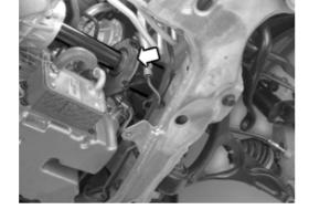
Dépose de la protection anticollision au-
